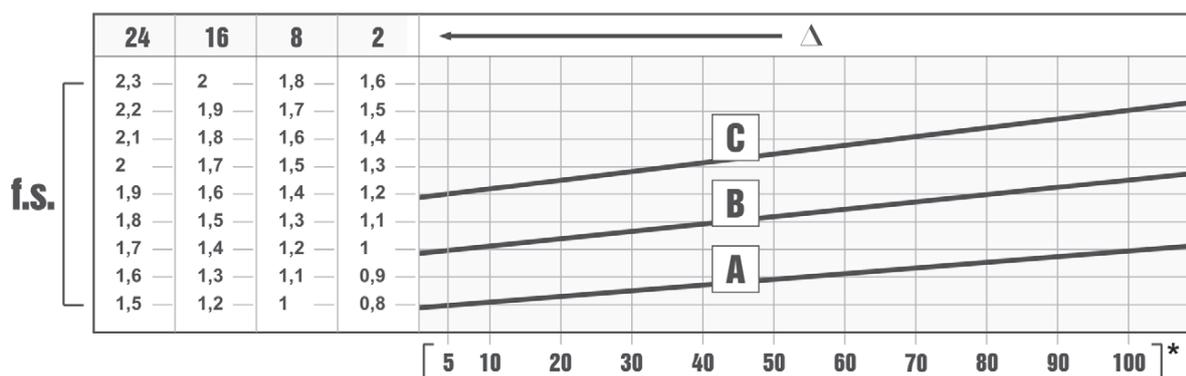
Сервис-фактор (f.s.) - это эксплуатационный коэффициент. Выбор редуктора следует делать исходя из количественных показателей тяжести предполагаемых условий эксплуатации. Номинальный сервис-фактор редуктора должен быть равен или быть больше расчетного значения данного коэффициента.
